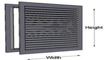
Return air Grille
